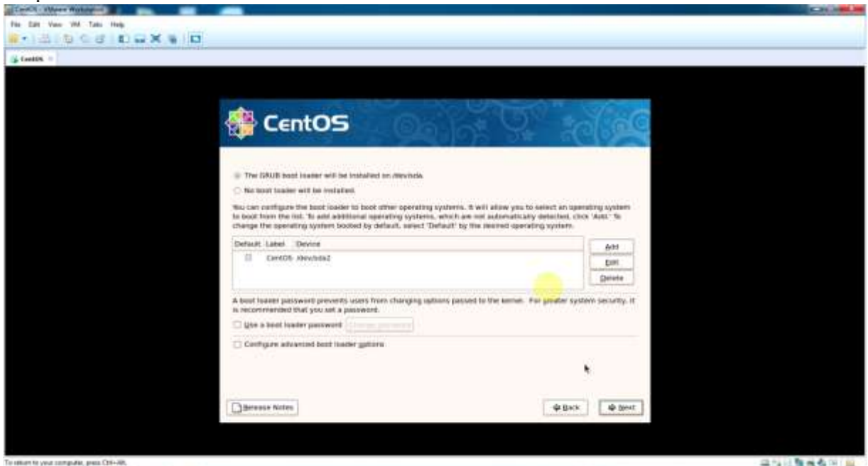
Hình 2.13 : Cài đặt chương trình boot loader GRUB và đặt password cho boot loader Chọn option The GRUB boot loader will be install on /dev/sda .
