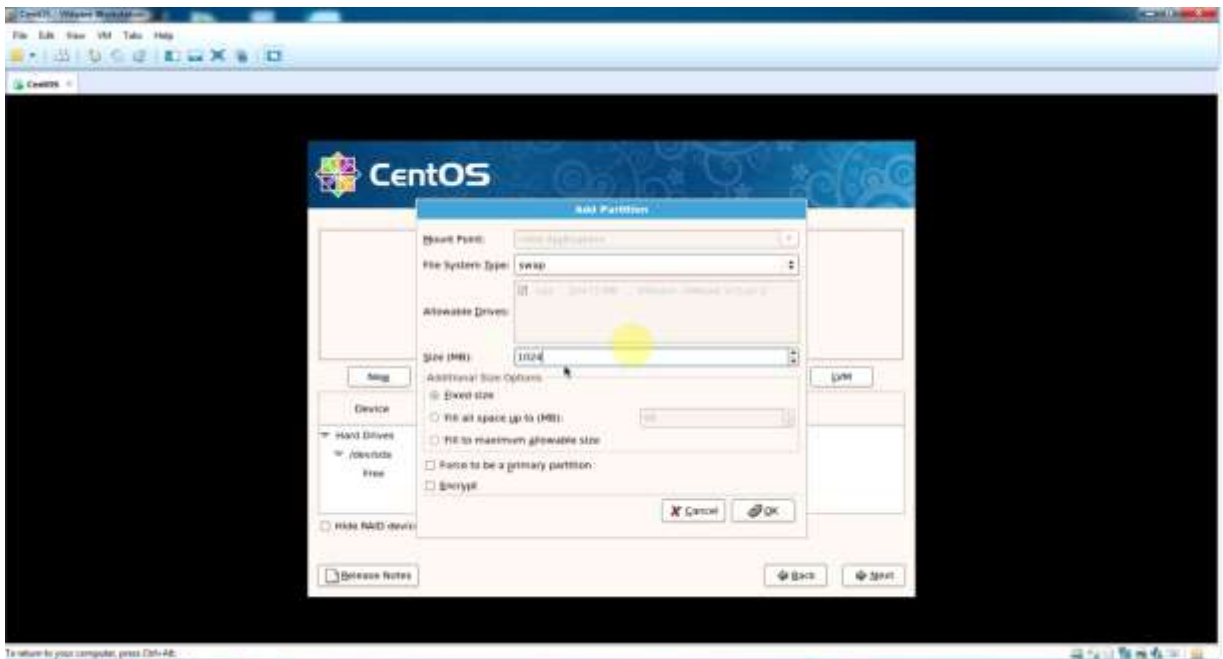
Hình 2.9 : Tạo các partition sau (swap) Chọn New để tạo partition swap Chọn File System Type : swap Chọn Size : 1024 (gấp 2 lần RAM) Chọn OK .
